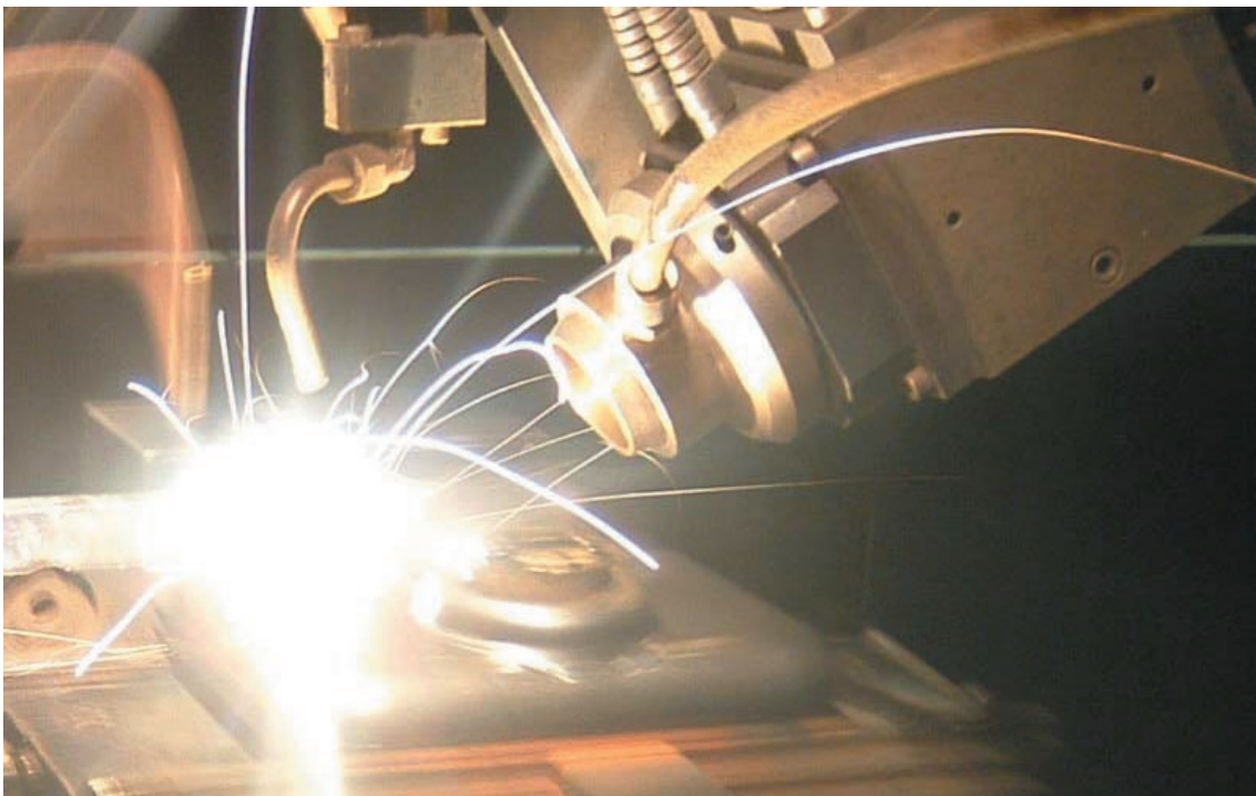
DETTAGLIO DELLA SALDATURA LASER DELLE TESTE DEL RADIATORE
